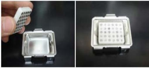
4. 삽입을 마친 Recipient Block은 Embedding mold에 cutting 면이 하향이 되도록 넣은 후 약 70°C 오븐서 30~60분간 Incubation합니다. (조직을 투입한 면이 커팅할 면이 됩니다.)
