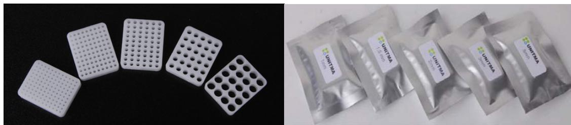
본사에서는 세계적인 특허기술로 개발된 가장 우수한 Recipient Block 을 제공합니다. 유니트마의 Recipient Block 은 TMA 작업에 앞서 Recipient Block 을 만드는 데에 드는 시간과 비용을 획기적으로 절감합니다. Recipient Block 은 70°C 의 온도에 30~60 분 정도 가열 시 녹게 되는 특수한 재료를 이용해 만들어졌습니다. 유니트마의 Recipient Block 은 디지털 장비와 함께 사용할 수 있도록 Tip size 에 맞는 정확한 규격의 hole 이 일정하게 배열되어 있습니다.
