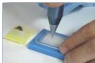
4. 한 손으로 prop과 guide를 고정시키고, 조직을 채취한 Quick Ray needle을 guide의 특정 hole에 넣은 후, 조직을 삽입합니다.
